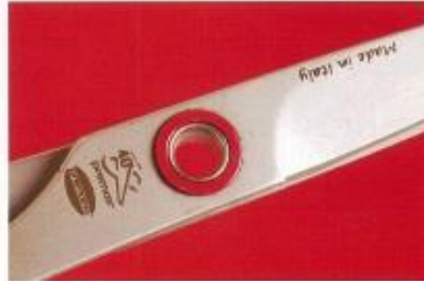
→ Il Ring lock system, composto da una bussola in acciaio inox, una in lega di alluminio e da un anello in Teflon assemblati con una macchina speciale ad alta precisione.
